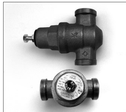
Figure 19 - Un détendeur est nécessaire si la pression d'eau du bâtiment est supérieure à 551 kPa (80 psi).
