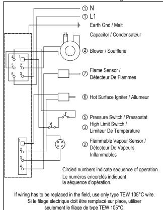
Electrical rating 120V 12A 60Hz. / Admissibles electriques 120V 12A 60Hz.
