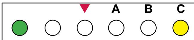
Le contrôle a détecté la présence de vapeurs inflammables près du chauffe-eau et il s'est verrouillé.
